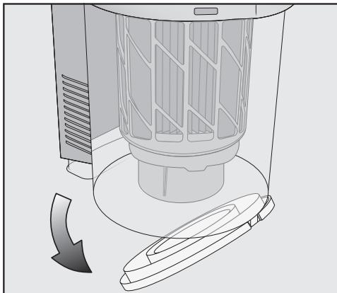
Die Klappe des Staubbehälters öffnet sich und der Staub fällt heraus.
